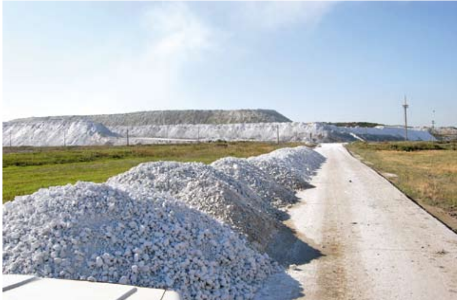
Опытная партия гипсового камня из фосфогипса перед отправкой на цементный завод на испытания
